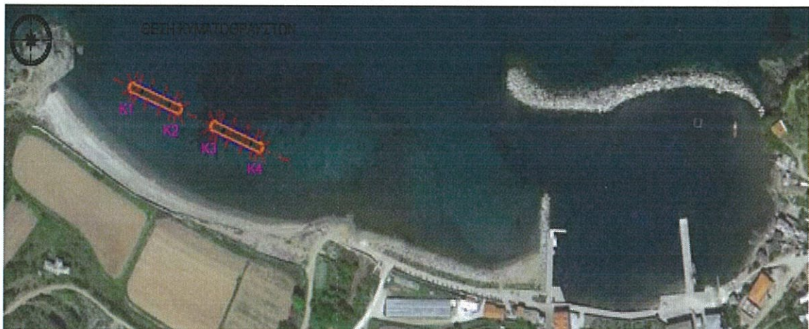
Σχήμα 3. Η χωροθέτηση των προτεινόμενων παράλληλων προς την ακτή κυματοθραυστών στον Όρμο Βατοπαιδίου.
