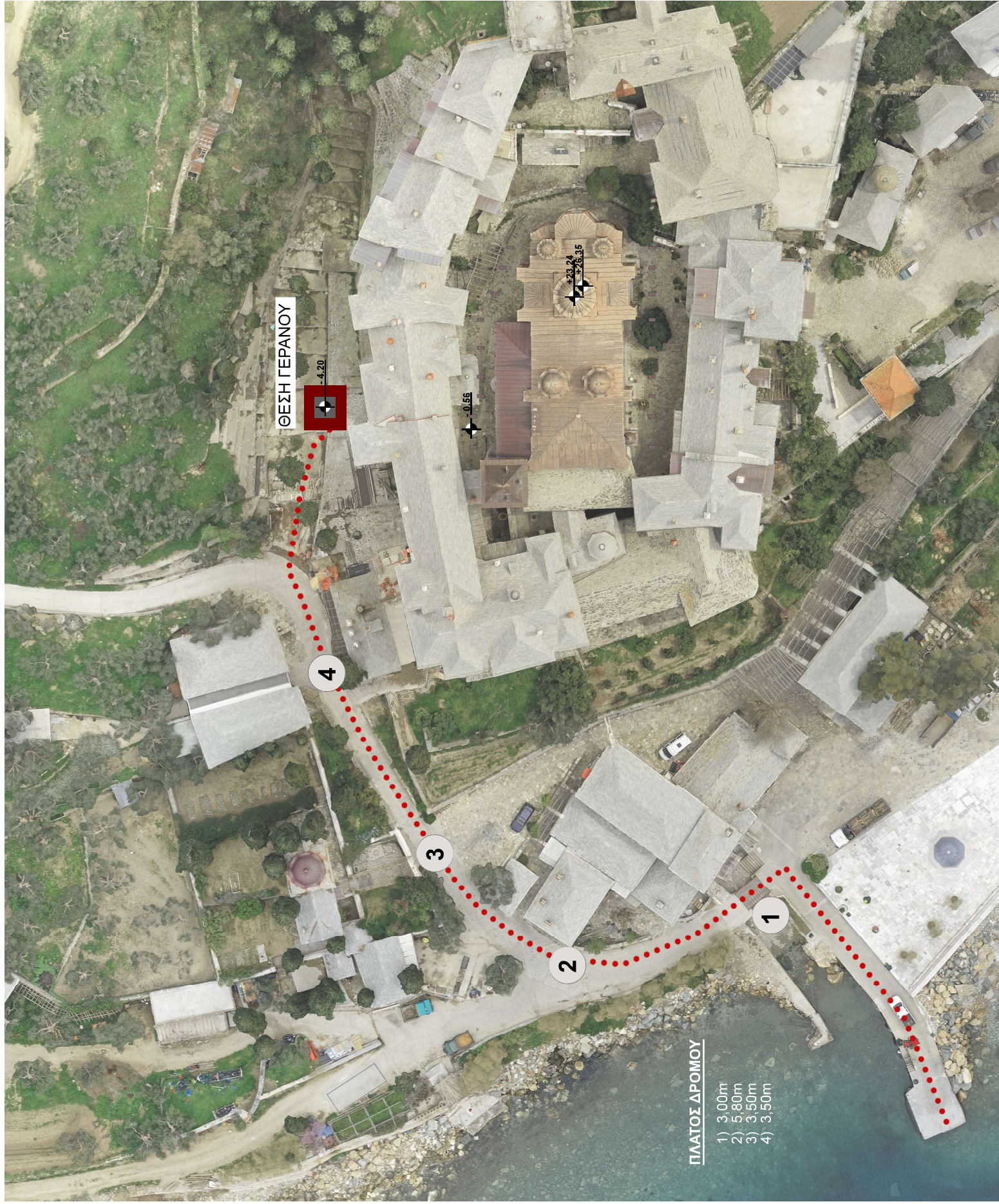
ΜΕΡΟΣ Γ: Απεικόνιση θέσης οικοδομικού γερανού και πλάτη δρόμου για τη μεταφορά του
